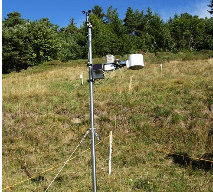
Station de mesures climatiques installée sur les prairies de Chermignon par le projet MontanAqua (photo : E. Reynard).
